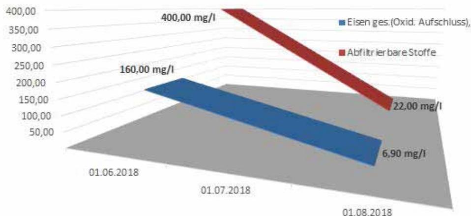
Durch den eingesetzten EnwaMatic®-Bypassfilter kann eine gleichbleibend hohe Wasserqualität im Kaltwassernetz gewährleistet werden. So können nicht nur ohne Einsatz von Chemikalien die strengen Vorgaben der Komponentenhersteller an die Wasserqualität eingehalten werden, sondern auch mittels der EnwaMatic®-Technologie eine Feinfiltration und Bakterienbarriere erreicht werden, was beim Betrieb eines teilsanierten Netzes die empfindlichen Anlagenteile weiterhin schützt.
