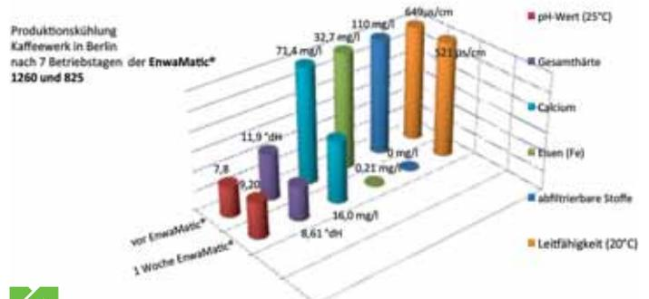
In die Produktionskühlanlage mit einer Leistung von ca. 500 kW wurden zwei EnwaMatic®-Bypassfilter in den Rücklauf integriert. Die fachgerechte Durchführung oblag dem Unternehmen WISAG.
