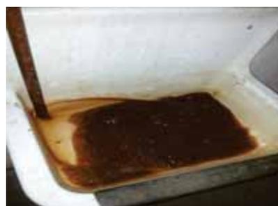
Partikel, die bei der automatischen Rückspülung aus dem Heizsystem entfernt werden - Dank der Effizienz des 5µm Feinfilters der EnwaMatic
