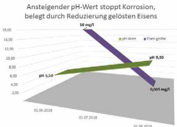
Durch die pH-Wert-Anhebung wird immer weniger gelöstes Eisen gebildet - die Korrosionsvorgänge kommen nachweislich zum Erliegen. Gleichzeitig lässt die pH-Wert-Anhebung das gelöste Eisen innerhalb der Filtermedien ausfallen, um es mit der automatischen Rückspülung aus dem System zu entfernen.
