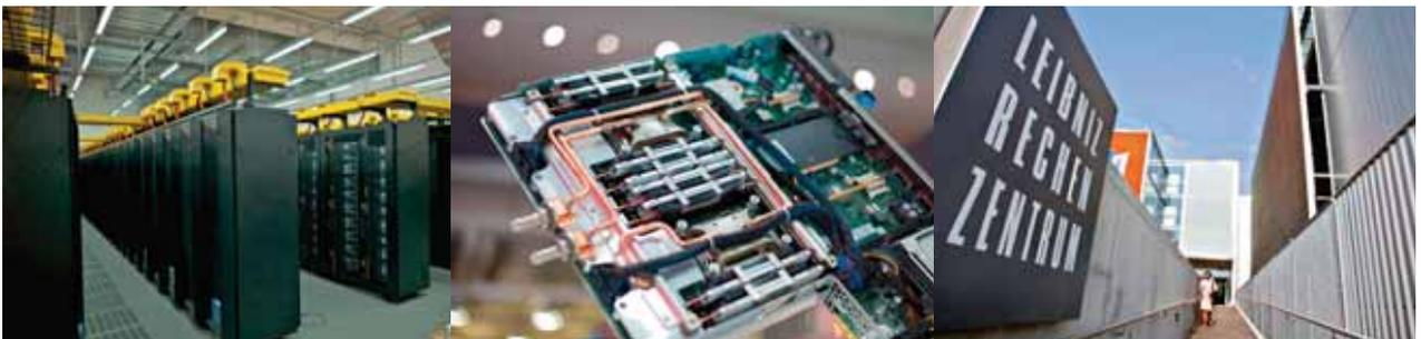
Wasserkühlung der IBM Servereinheiten (Quelle: IBM Research)
