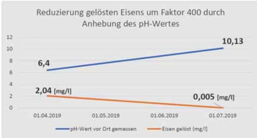
Bei aktuellem Wert des gelösten Eisens von nur 0,005 [mg/l] spricht man davon, dass technisch keine messbare Korrosion mehr stattfindet.
